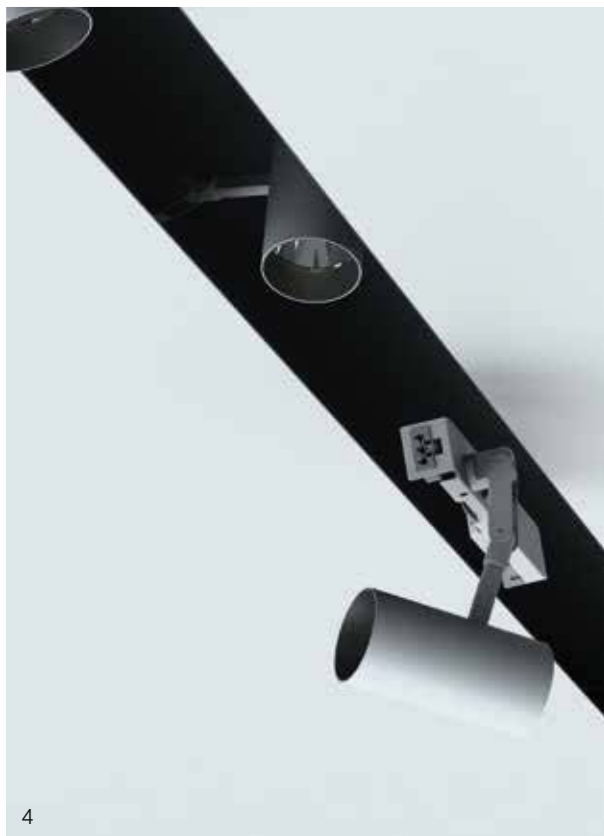
Zwei Schienen erlauben die Installation der Spots entweder links oder rechts im Kanal. Die Stromzufuhr wird über Anschlussstecker an jedem einzelnen Spot und entsprechende Verbindungskabel gelöst.
